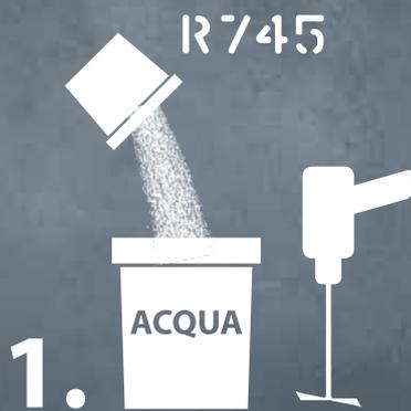
Versare la polvere colorante R745 TERRE NATURALI in un recipiente contenente la quantità di acqua necessaria al successivo impasto del prodotto R311 CEMENTO MADRE FINE (30-40% in peso di acqua). Agitare meccanicamente la soluzione colorata fino ad ottenere una perfetta dispersione della polvere R745.
