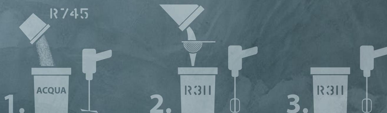
Versare la polvere colorante **R745 TERRE NATURALI** in un recipiente contenente la quantità di acqua necessaria al successivo impasto del prodotto **R311 CEMENTO MADRE FINE** (30-40% in peso di acqua). Agitare meccanicamente la soluzione colorata fino ad ottenere una perfetta dispersione della polvere R745.
